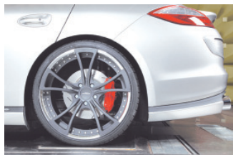
Design: Die gefräste und geschmiedete 3-teilige 22-Zoll Felge LSC-FORGED mit Felgenstern in wuchtigen 23-Zoll.
