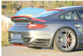
Aerodynamik: Der BTR-II mit Frontspoilerlippe, Seitenschweller, Heckdiffusor und Heckspoiler.
