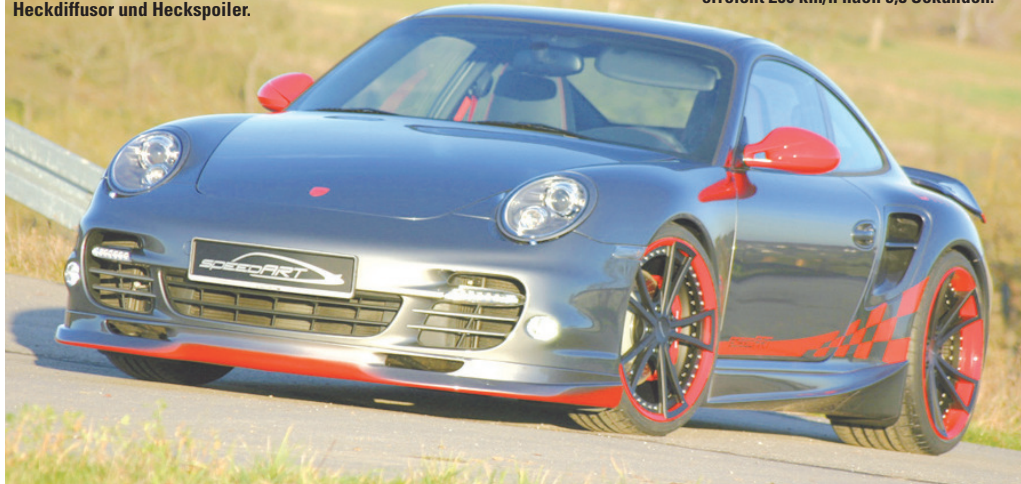
Aerodynamik: Der BTR-II mit Frontspoilerlippe, Seitenschweller, Heckdiffusor und Heckspoiler.
